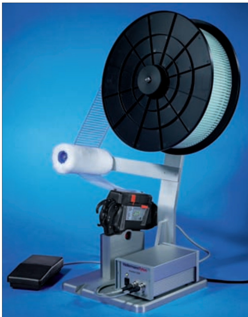
Набор для стационарной установки, патронташная катушка, Autotool 2000 и аккумулятор.
